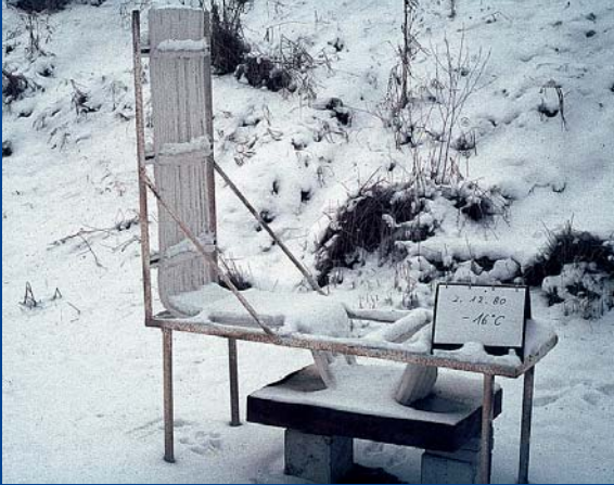
02. December 1980 - The cable tray covered with snow at -16°C 02. Dezember 1980 - Die Kabeltrasse, schneebedeckt bei -16°C
