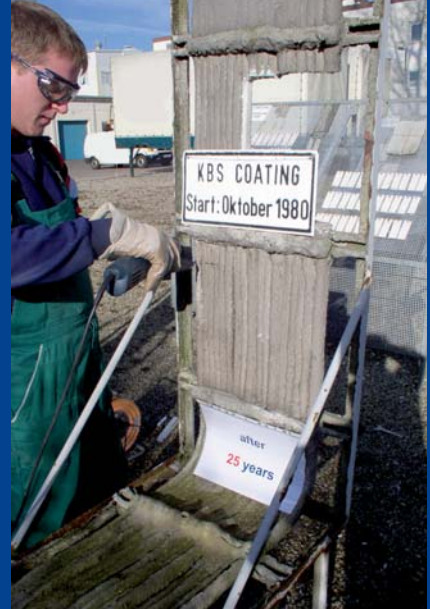
The coated cables - in perfect shape even after 25 years outdoor exposure. Die beschichteten Kabel - auch noch nach 25 Jahren in exzellentem Zustand.
